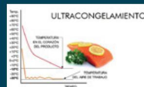
El máximo tiempo de almacenamiento se alcanza a través de la rápida producción de frío, el cual permite la formación de microcristales. Estos cristales preservan de manera óptima las celdas de la comida (a diferencia de los macrocristales que des-truyen las celdas, lo que sucede cuando enfriamiento es lento).
