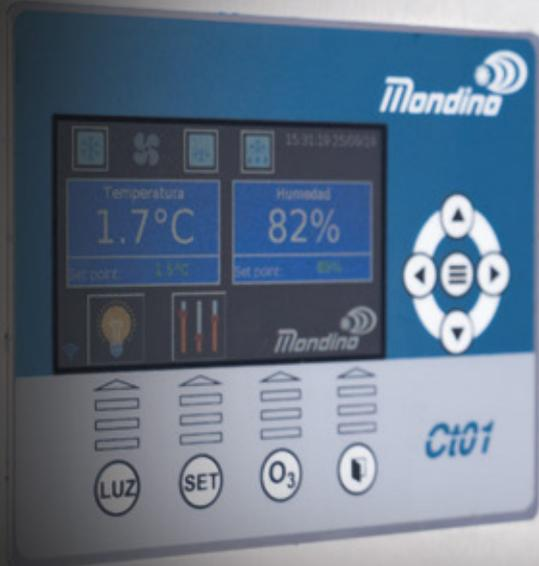
CT01 es un revolucionario sistema de control programable equipado con un software dedicado al procesamiento de alimentos de forma tradicional. Muy intuitivo y fácil de usar gracias a una gran pantalla 7 pulgadas en color con alta resolución gráfica, gestiona automáticamente el control secuencial de todas las etapas de maduración de la carne, midiendo también los procesos de fermentación.
